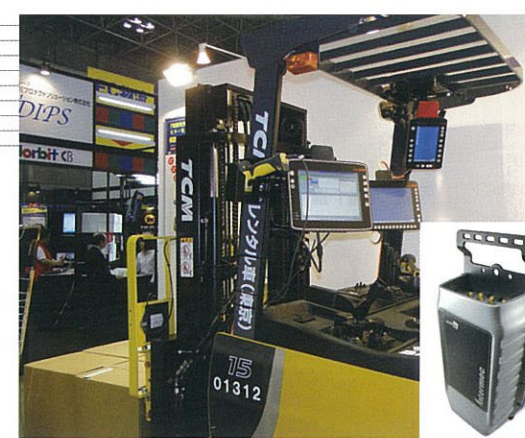
写真-2,3 A-DLoG 端末のマウント状況とインターメックのIV-7
